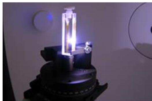
Abb.: Phosphore konvertieren blaues LED-/Laser-Licht in weißes Licht
